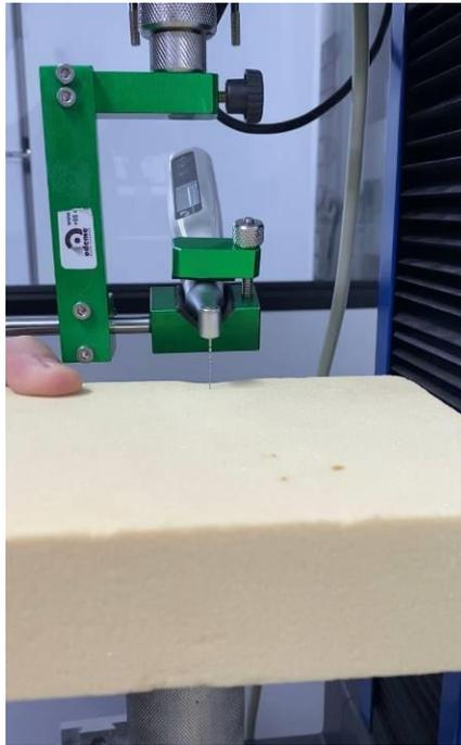
**Figura 4.** Aparato para ensaio de capacidade de corte
