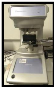
Figura 15. Microdurômetro digital shimadzu modelo MHV-G 21
