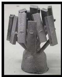
Figura 7. Cps de prova na base dos sprues pós fundição IE, pós jateamento com óxido de alumínio.
