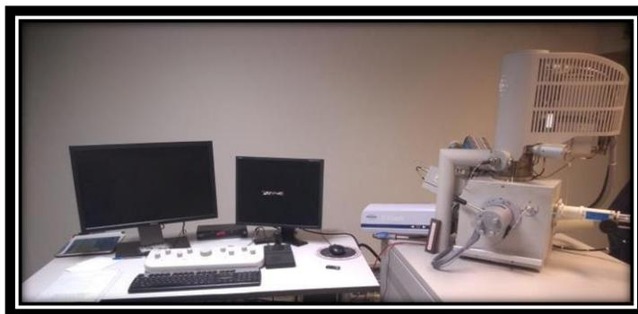
Figura 18. MEV equipamento QUANTA FEI 250
