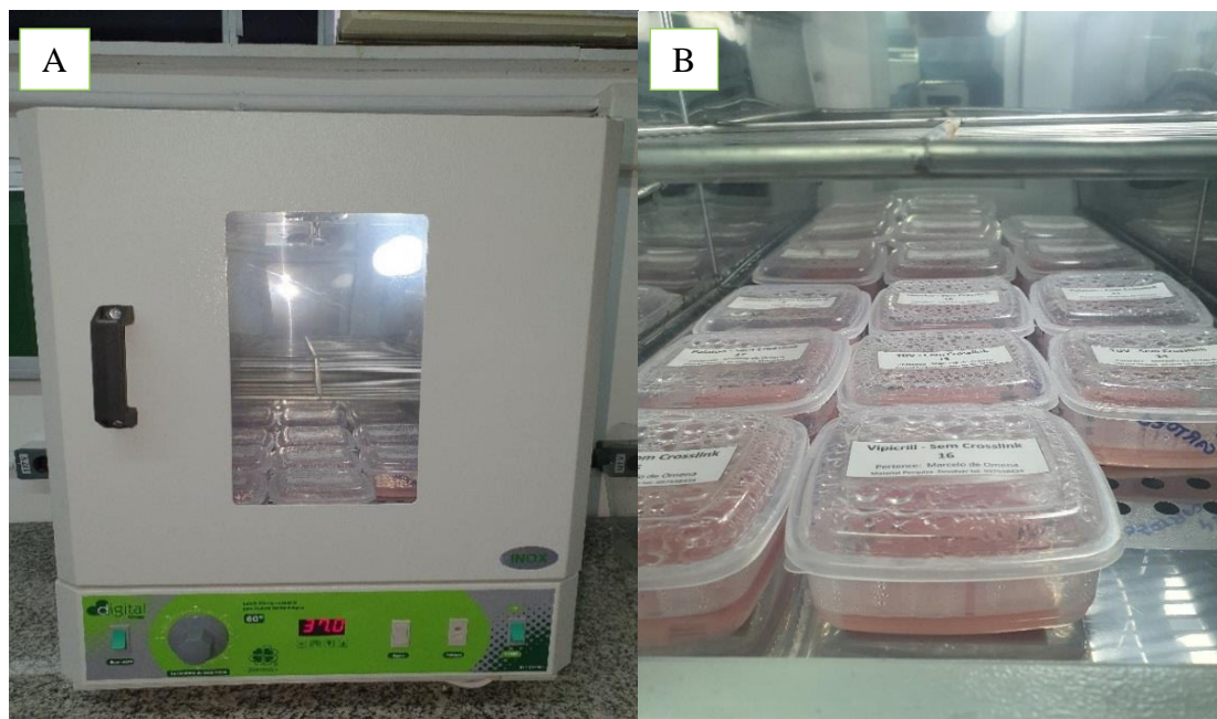
Figura. 10 Estufa ( 37 \pm 1 ) °C por ( 50 \pm 2 ) horas (A), recipientes com amostras imersas água (B).
