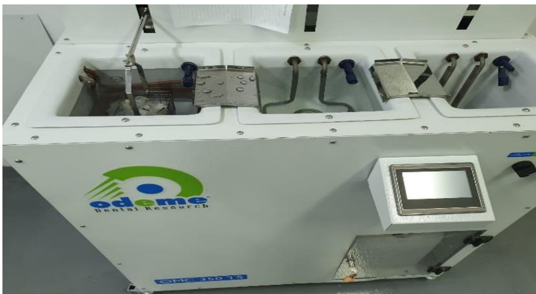
Figura. 8: Termociladora de 3 cubas com temperaturas de 5°C, 37°C e 55°C
