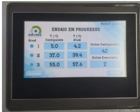
Figura 3 - Visualização do painel do equipamento com os ajustes nos quais foram realizados os ensaios.
