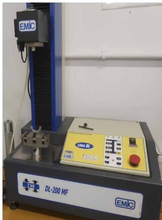
Figura 5 – Máquina EMIC DL 200 MF utilizada para flexão em 3 pontos.
