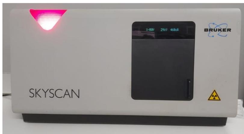
Figura 4 - Microtomógrafo Bruker utilizado na análise de variação dimensional dos alinhadores.
