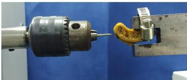
**Figura 2** – Ensaio de torque de instalação nos CPs/Bone. Adaptação dos MIEAS e dos CPs/Bone no torquímetro de mesa.
