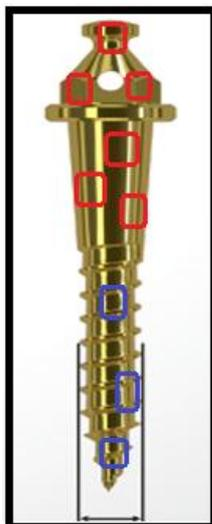
**Figura 7.** – Figura esquemática da microanálise de superfície metálica no MEV, sendo obtidas 3 áreas na região do perfil transmucoso e slot, que foram expostas aos meios de cultura; e 3 áreas na região de rosca perfurante, em contato com o osso anteriormente, sem exposição direta ao meio de cultura.
