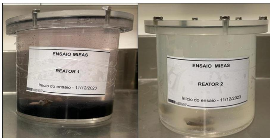
**Figura 6** – Biorreator BRS (1) e Biorreator Control. (2). Formação de sulfeto ferroso no biorreator BRS após inoculação, tempo zero do ensaio (1).
