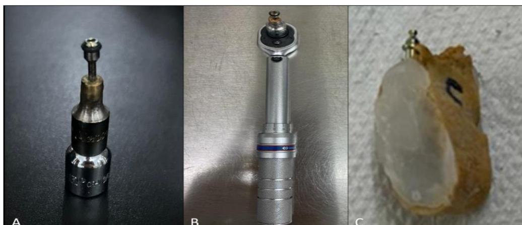
**Figura 5** – Chave digital CDPO24 adaptada a um soquete (A); Torquímetro manual King Tony  $\frac{1}{4}$  15Nm adaptado a chave digital CDPO24 do Kit SIN (B); Man-Bone/MIEAs selado com cera branca ortodôntica (C).
