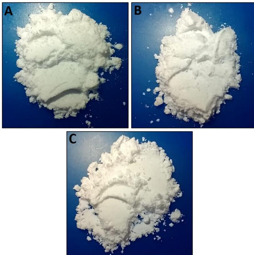
**Figura 3:** Hidroxiapatita carbonatada nanoestruturada sintetizada por via úmida em diferentes temperaturas, com aparência semelhante a de um pó branco. (A) Sintetizada a 5°C. (B) Sintetizada a 37°C. (C) Sintetizada a 90°C.
