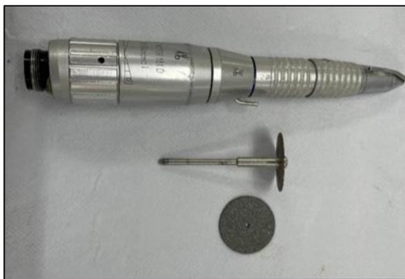
**Figura 4.** Micromotor e disco de lixa em mandril, utilizado nos corpos de prova. Foram seccionadas em regiões anteriores e posteriores
