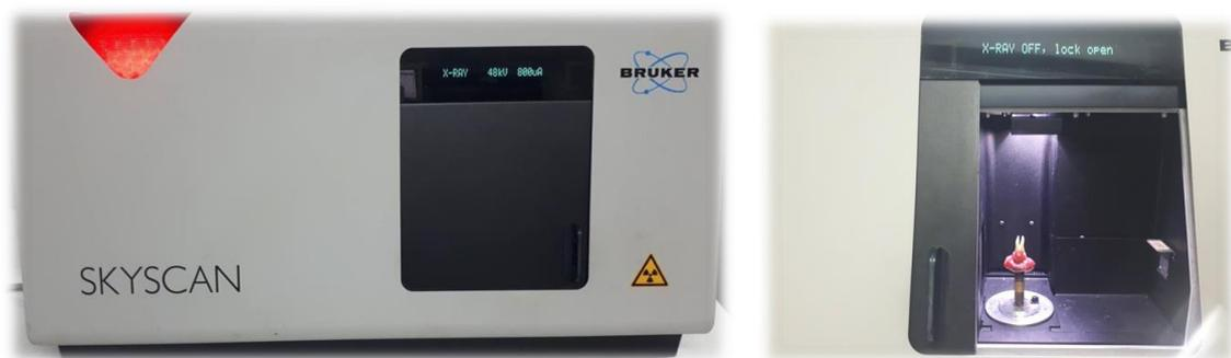
**Figura 3.** Microtomógrafo SkyScan 1174 v.2 (Bruker microCT, Kontich, Bélgica).
