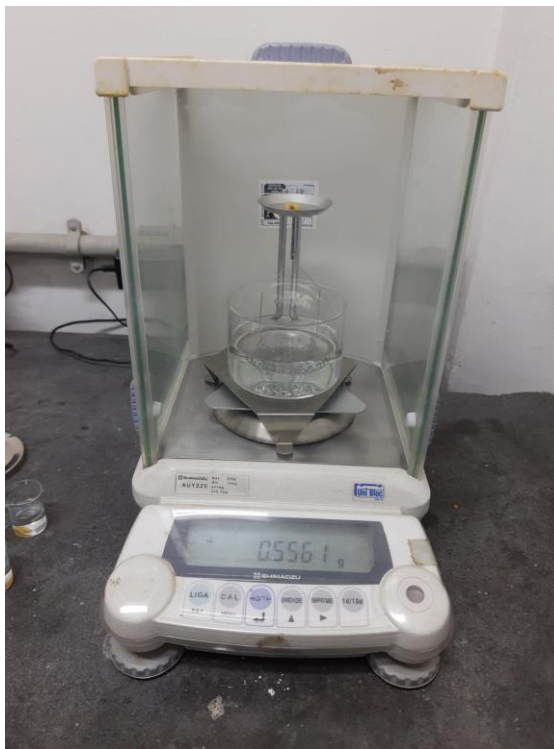
Figura 4 – kit para determinação da densidade de sólidos por princípio de Arquimedes, pertencente ao LATEP/DIMAT/INT.
