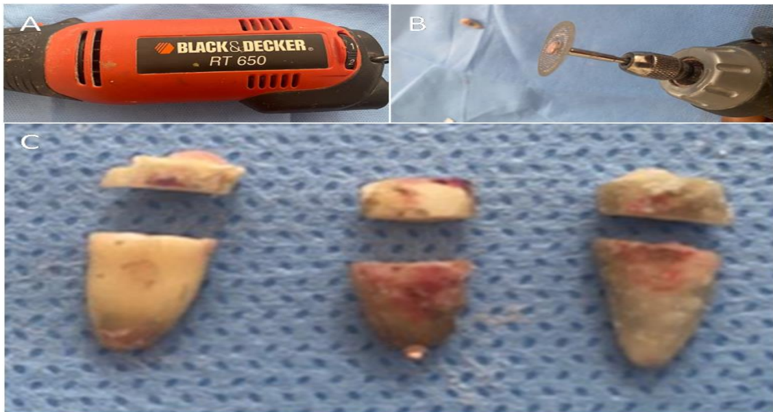
Figura 4. Secção dos Corpos de prova. Microretífica utilizada na secção (Imag. A) e o disco de serra diamantado dupla face total (Imag. B) utilizada para o corte dos Cps (Imag. C).
