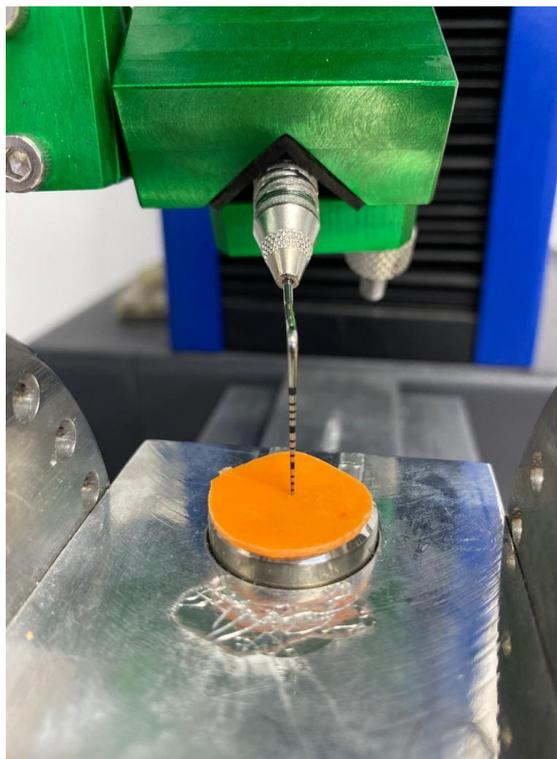
Fig 3. Membrana de silicone posicionada durante a realização do ensaio.
