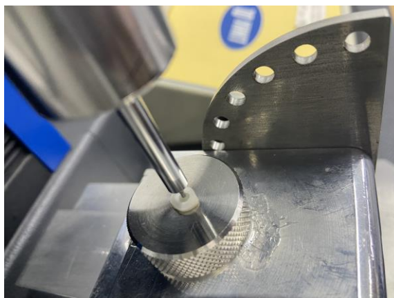
Figura 3. Atuador no centro da amostra durante ensaio de micro push-out .
